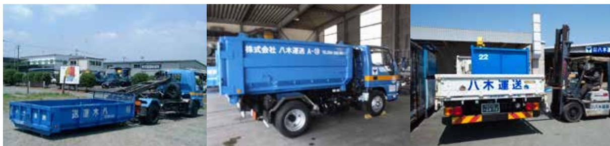
コンテナ専用のロールオン車。現場に設置したコンテナをた、定期的に交換します。交換作業は短時間で終わります。
